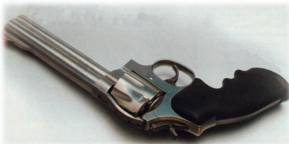
**Notausstieg.** Erhöhter Gasdruck von handgeladener Munition sprengte diesen Revolver. Doch auch wenn es nicht zu diesen drastischen Erscheinungen kommt, ist zu hoher Gasdruck nicht nur gefährlich, sondern auch leicht vermeidbar und unnötig.
