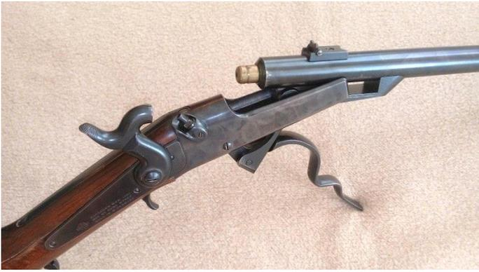
Abb.: Gallager geöffnet, bereit zum Herausziehen der abgeschossenen Ladehülse
