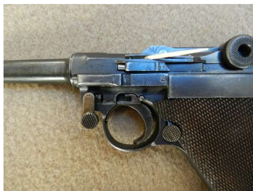
Abb 4.: Schön sichtbar die Nocke vorne an der Federstange, die nach Abnahme der Deckplatte von oben in die Abzugsstange eingreift.
