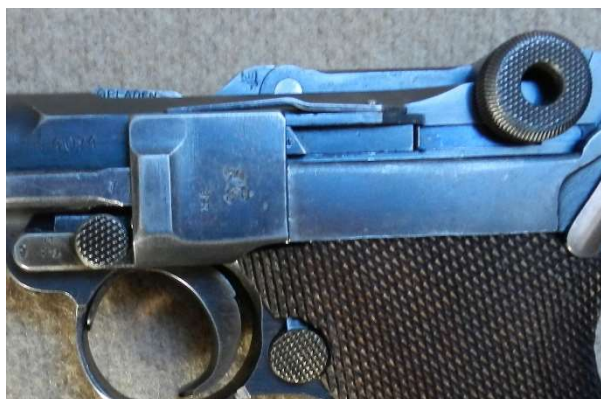
Abb.2: Pistole 08 aus dem Ersten Weltkrieg, nachträglich ausgestattet mit einer Schiwy-Sicherung (oberhalb von Deckplatte und Abzugsstange angenietete längliche, leicht geknickte Federstange).
