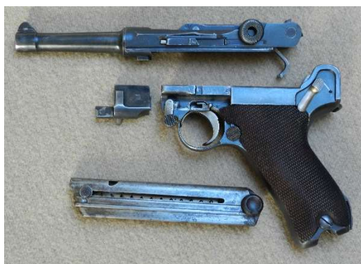
Abb. 3: Bei teilzerlegter Pistole konnte immer noch eine sich im Lauf befindliche Patrone allein durch seitlichen Druck auf die Abzugsstange ausgelöst werden.
