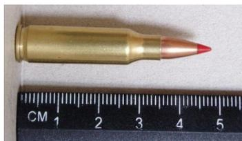
Abb.: Patrone .221 Remington Fireball. 1963 mit der Remington-Pistole XP 100 für die Jagd auf Kleinwild herausgebracht. Auch auf größere Distanzen präzise, erreichte das 3,2 Gramm schwere Geschoss aus 27,6 cm langem Lauf eine Vo (Mündungsgeschwindigkeit) von ca. 800 m/sec und eine Mündungsenergie von etwa 1.000 Joule.
