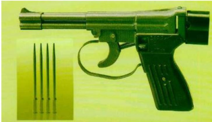
Das Stahlgeschoss hat einen Durchmesser von 4,5 mm, ist ca. 120 mm lang und hat ein Gewicht von 12,8 Gramm. Die Mündungsgeschwindigkeit betrug angeblich um die 240 m/sec.
