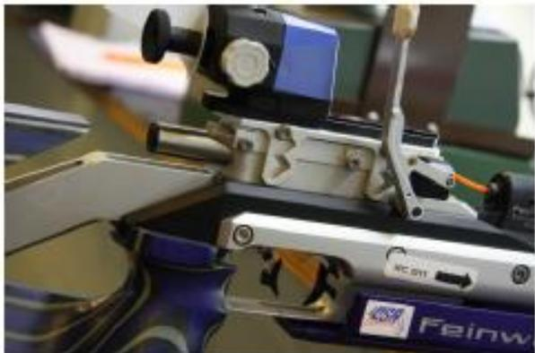
**Abzugsverlängerung:** Der Abzug befindet sich innerhalb der Abmessungen der ISSF-Regel und ist durch einen Abzugsbügel geschützt.
