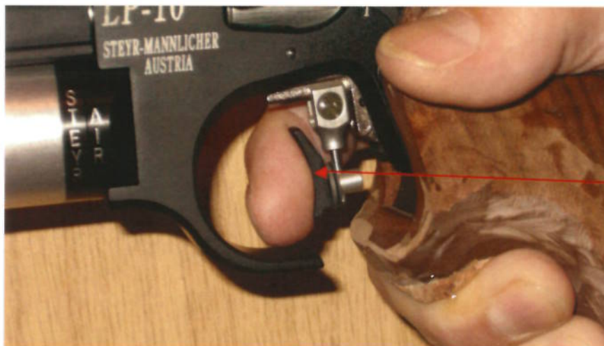
Bild 6: Kontrolle des gleichförmigen Greifens – Lage des Abzugsfingers
