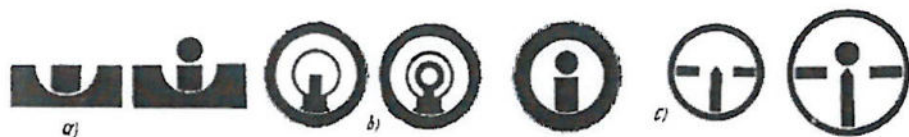
Abb. 13: Zieleinrichtungen: Balkenkorn, Ringkorn, Zielfernrohr. Rechte Hälfte mit Darstellung des Scheibenspiegels. Dieser wird allerdings nicht so scharf gesehen, wie hier dargestellt, da sich die Zone des schärfsten Sehens auf dem Korn befinden muss.
