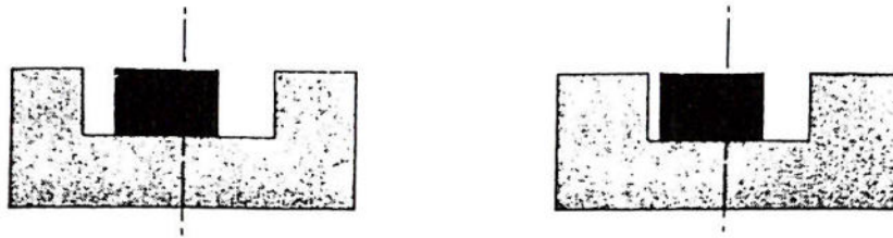
Der Vorteil einer breitflächigen Visierung: Der Fehler in der Lage des Korns ist bei beiden Visierungen gleich, aber er erscheint bei der OSP (links) geringer.
