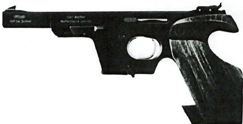
Die Visierung einer Schnellfeuerpistole ist verstellbar.
