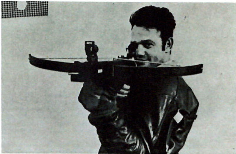
Eine moderne Armbrust. Die geflochtene Stahlsehne wird mit einer Spann- gabel gespannt. Wird nun der Bolzen in die Stahlbahn mit einem Schlitten ingelegt, ist die Waffe schußbereit.
