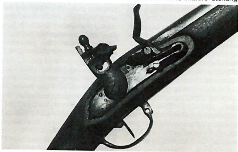
Das Steinschloß, mittlere Stellung.
