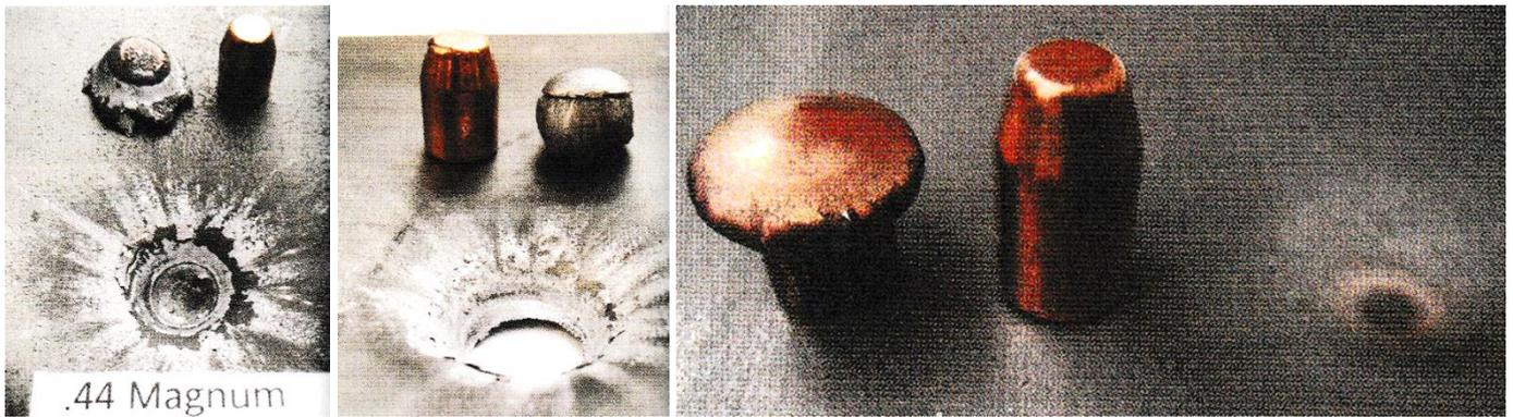
**Red kein Blech:** Gegen Stahl hilft nur Gewalt, aber bei vier Millimeter starkem Blech ist auch für die .44 Magnum Schluss (links), die drei Millimeter schafft sie noch gerade (Mitte). Die 38er (rechts) macht schon bei zwei Millimeter dickem Stahl schlapp und sieht danach wie ein Waldgewächs aus.
