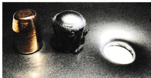
Oben: Wie ein Helm haftet das ausgestanzte Blech auf der Geschößspitze der 44er und stabilisiert das Projektil. Unten: Auch vom Aluminium nimmt die starke Laborierung einen Teil mit. Die 44 Magnum ...
