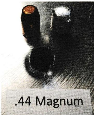
... setzt beim Aufprall extrem viel Energie frei. Ist der Druck groß genug, verflüssigen sich die Metalle von Geschöß und Ziel beim Zusammenstoß kurzzeitig und gehen eine dauerhafte Verbindung ein. Der Fachmann nennt dieses metallurgische Phänomen Explosivschweißen. In der Industrie wird der Effekt gern genutzt, denn Sprengstoff ist oft billiger als Maschinen.
